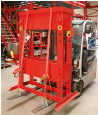
Ladungssicherung mit Gabelklemmen und Spanngurten
