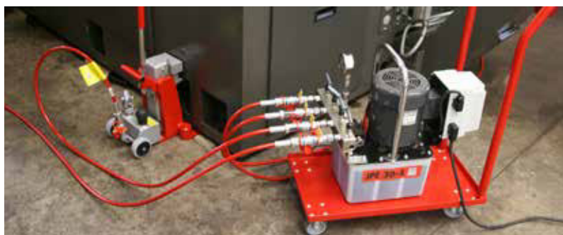
Elektropumpe JPE 30/4 NVR mit 4 Hebeegeräten im Einsatz
