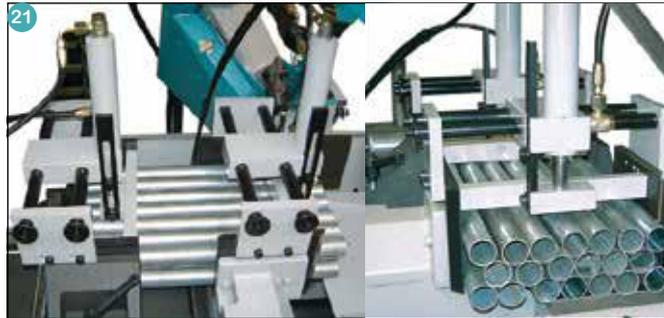
21 Hydraulische Bündelspanvorrichtung
