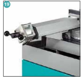
19 Pneumatischer Spannstock
